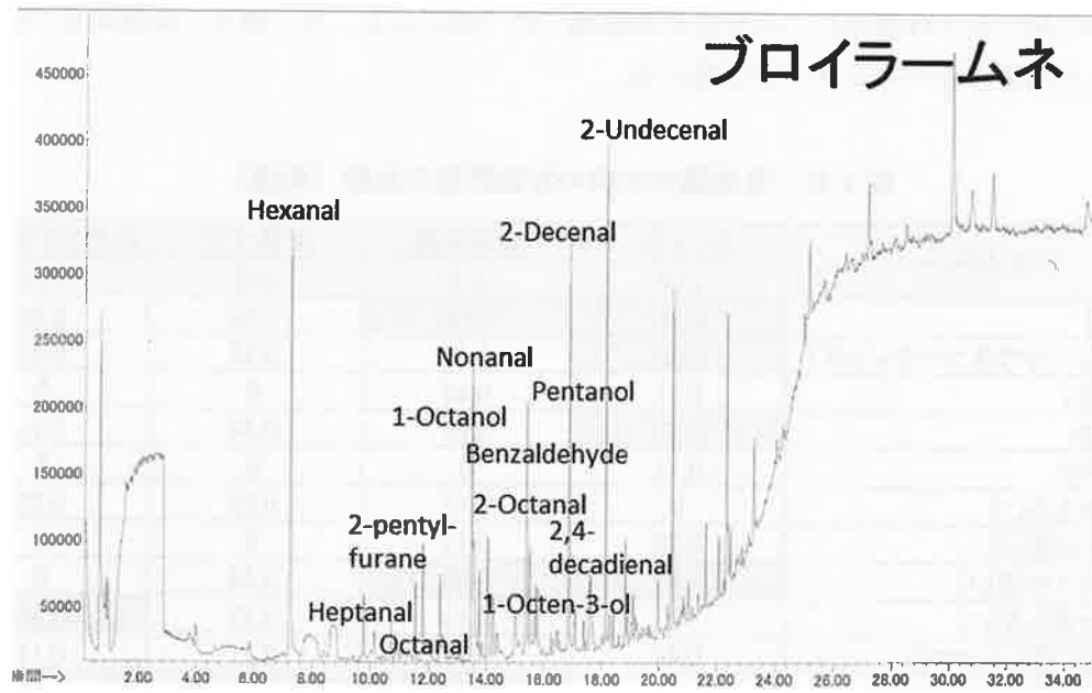
図16. ブロイラーから検出される香気成分と GC/MS クロマトグラム
